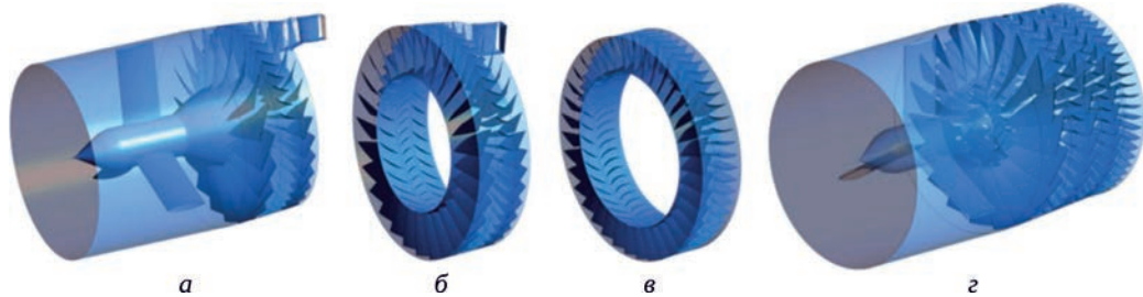
Рис. 5. Аэродинамические модели: а – модель C1; б – модель C2; в – модель C3; г – полная модель (П) компрессора
