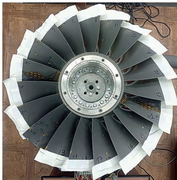
Рис. 2. Установленный на вибростенде блиск
